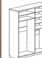
Данная секция устанавливается в шкаф П7.043.1.11 (в левое отделение) и фиксируется при помощи стяжек.
